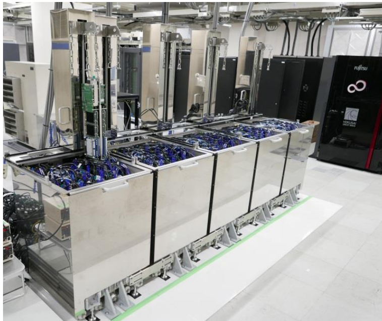
Figure 11: Un système de refroidissement par immersion de PEZY/ExaScaler utilisant un fluide diélectrique 3M™ Fluorinert™ (supercalculateur Shoubu) 45
